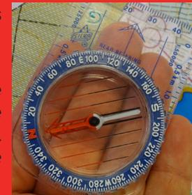
• Pivotez jusqu'à ce que le bout rouge de l'aiguille pointe sur le Nord du boîtier. La flèche sur la plaque indique la direction à suivre.
